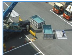
運搬容器 水漏・吊具・フォークポケット 試験
