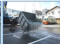
運搬容器 水漏・吊具・フォークポケット 試験
